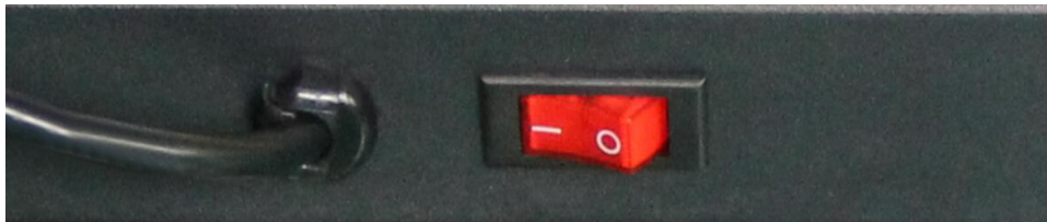
Вимикач живлення (червоний) на передній частині кришки мотора
